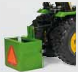
Caisson de lestage
